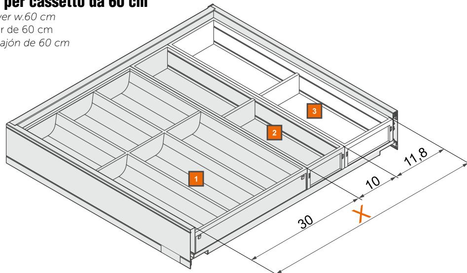
**"X"** È la dimensione del vano interno del cassetto e si calcola nel seguente modo:
